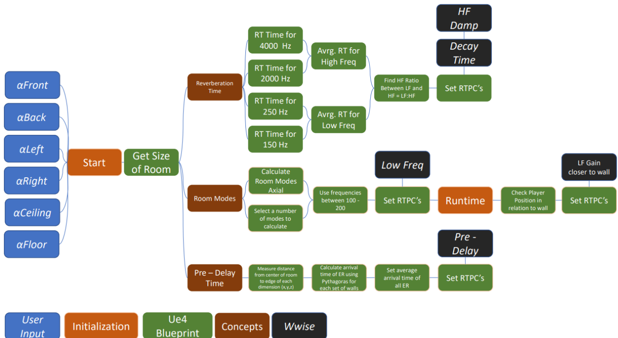
Figur 45: Eget flytskjema for implementasjonen av romklang i undersystemet for lydubredelse.
