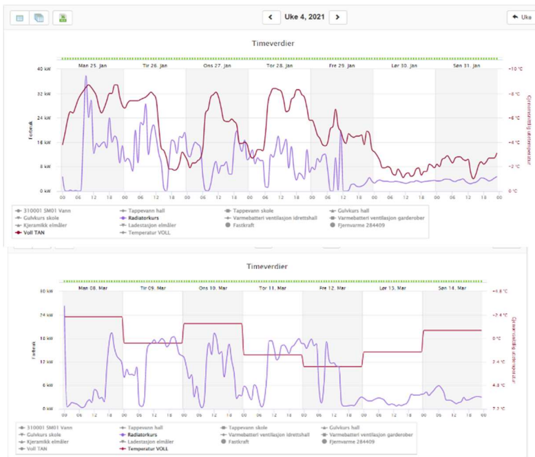
Figur 37 Eksempler på normal forbruk av radiatorkurs på Lade skole (kilde: Esave)
