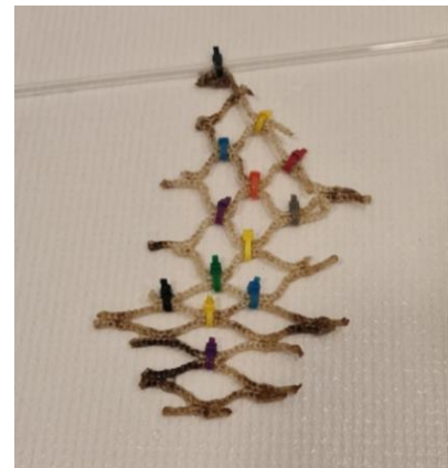
Bilde 1: Not markert for prøvetaking med fargede strips. Denne ble festet til glasstav ved bruk av strips, not ble deretter suspendert i vekstmediet i bioreaktor.
