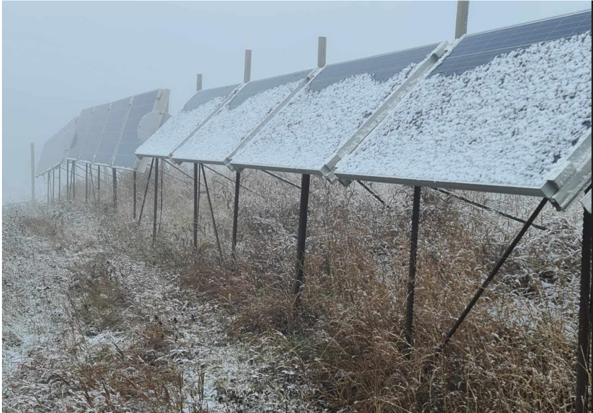
Figur 7: Bildet over er fra solparken til Helge og viser forskjellen mellom vinklingen på 73 og 45 grader etter et lite snøfall. Det er betydelig forskjell på de bakerste på 73 grader og de på 45 grader med tanke på hvordan snøen holder seg på panelene (Personlig kommunikasjon, 2022)
