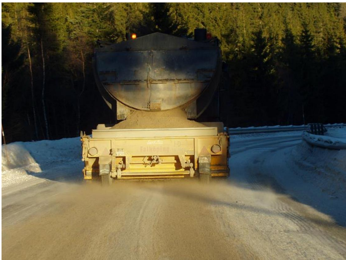
Figur 13: Tørrsandstrøing (Thomassen, et al., 2015)
