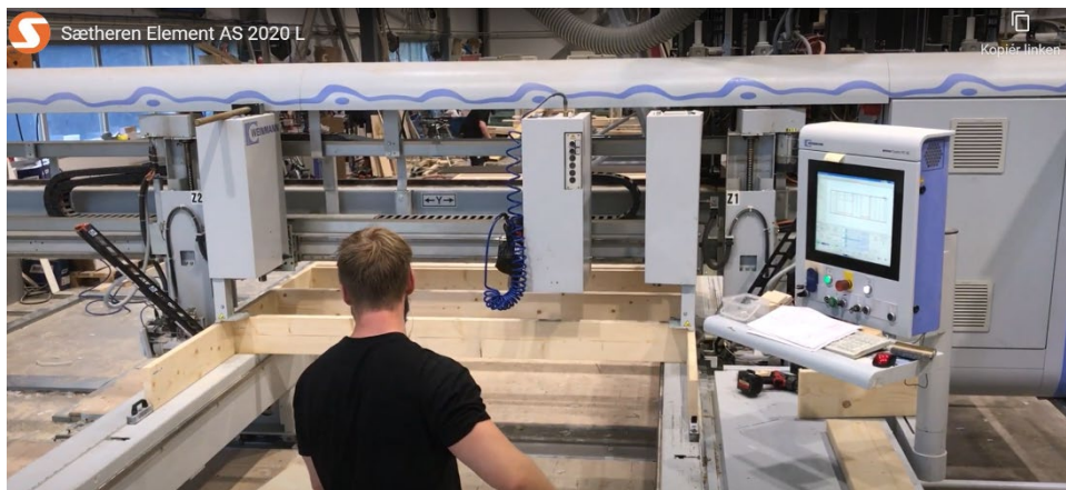
Figur 34 Sætheren Element legger og spikrer bjelkelag manuelt
