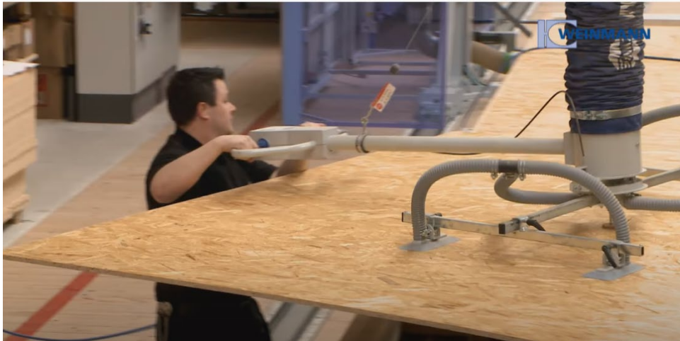
Figur 35 Håndtering av store treplater med vakuumløfter fra Weinmann.
