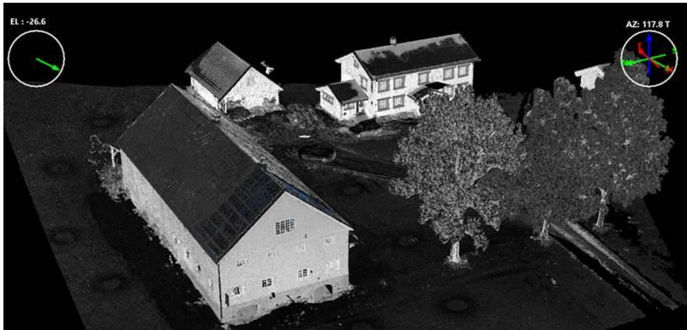
Figur 9 Punktsky av låven i Kviteseid i Telemark. Laserskanning gjort av Tormod Urke.
