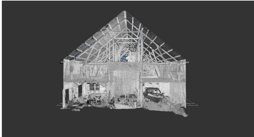
Figur 11 Viser hvordan punktskyen av låven i Kviteseid i Telemark ser ut inni. Laserskanning gjort av Tormod Urke
