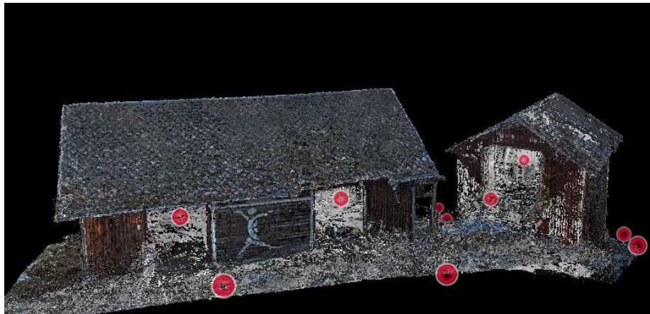
Figur 12 Viser punktsky av låvene i Nes i Ådal, og røde sirkler med oversikt over hvor laserskanningen har blitt utført. Punktsky gjort av Tormod Urke
