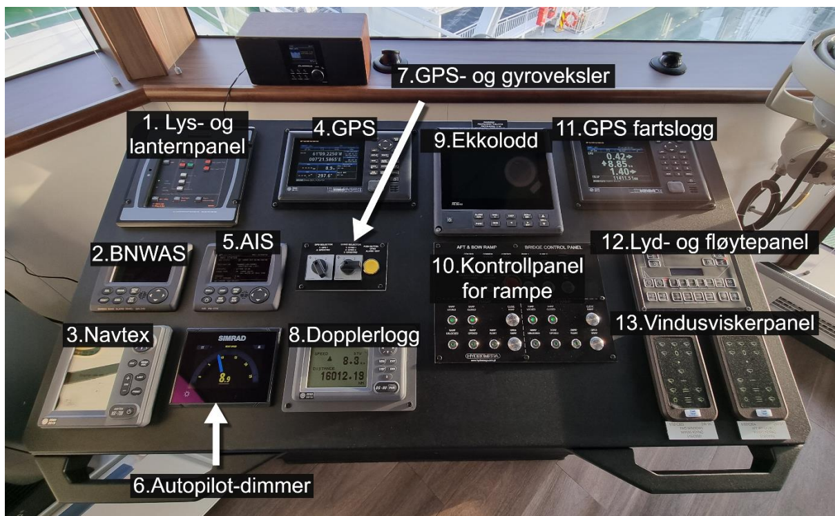
Figur 3: Navigasjonskonsoll, oversikt over komponenter. Foto: Eget
