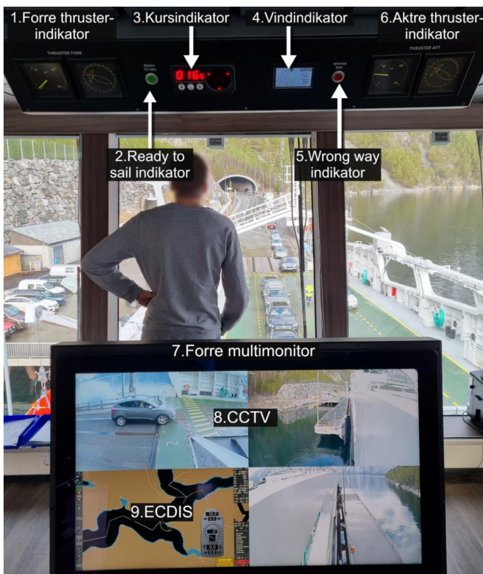
Figur 5: Forre- og aktre panel, oversikt over komponenter. Foto: Eget
