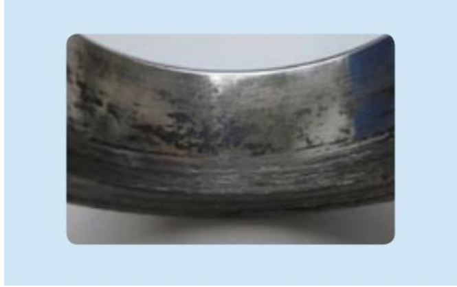
Figur 2.9 Creep på lagerets indre-ringveg (8)
