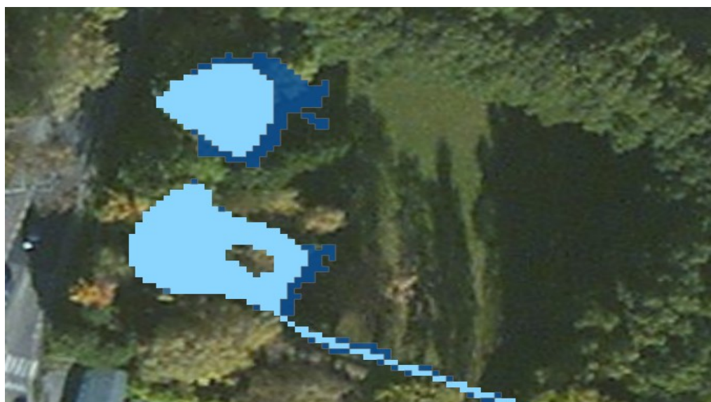
Figur 69: Lyseblå polygon representerer vannområder. Mørkeblå representerer kartlagt forsenkning.
