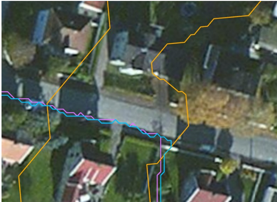
Figur 58: drenslinjer basert på 10 m terrengmodell (oransje), drenslinjer basert på 1 m terrengmodell (blå) og drenslinjer basert på 25 cm terrengmodell (rosa).
