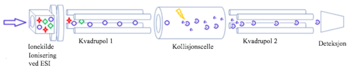
Figur 4: Deteksjon med tandem massespektrometri. I kvadrupol 1 blir ioner selektert i et massefilter. I kollisjonscellen blir ioner fragmentert. I kvadrupol 2 blir fragmenterte ioner selektert i et massefilter og sendt inn en etter en til detektoren som detekterer ioniserte fragmenter som elektriske signal (15).
