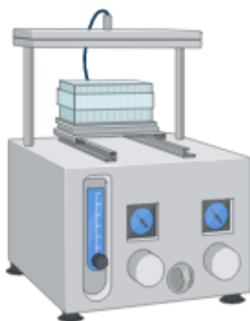
Figur 10: Ostroplate og dyprønnsplate plassert på PPP-modulen (33).
