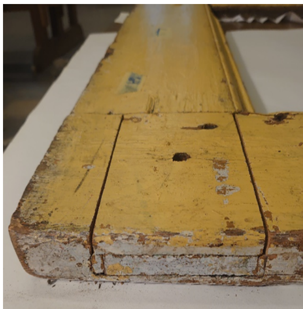
BILDE 73 – TAPPFORBINDELSE. SAGD FOR UNDERSØKING
