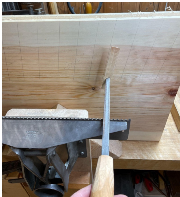
BILDE 104 - FILING AV LANGVEDSAG MED TREKANTFIL
