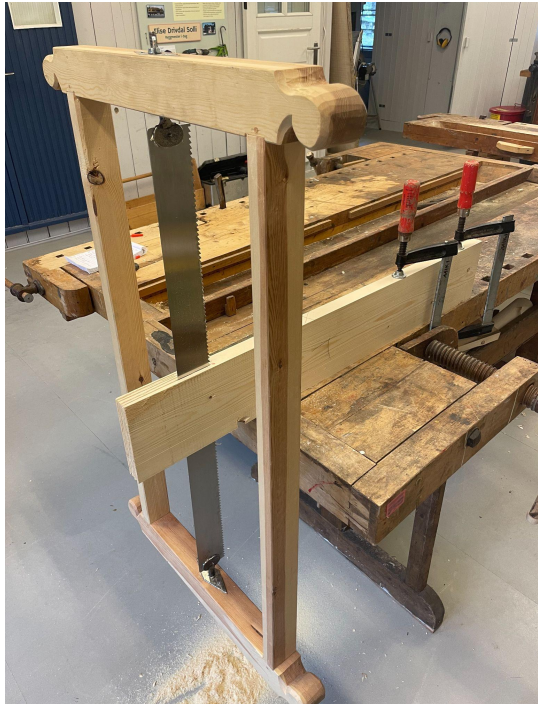
BILDE 70 – FESTING AV EMNE PÅ KANT OPP PÅ BENKEN. BENKEHAKER HADDE VÆRT Å FORETREKKE FREMFOR TVINGER.
