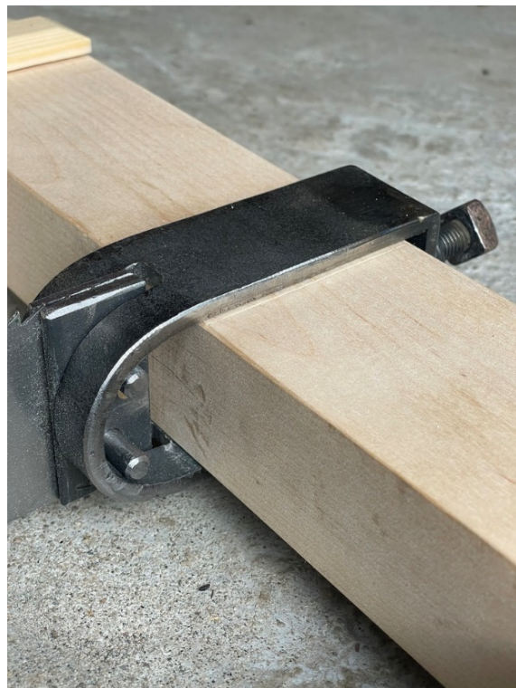
BILDE 112 - STRAMMEMEKANISME RAMMESAG "BESTEMOR"
