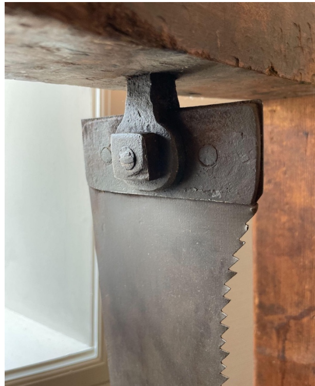
BILDE 91 – INNFESTING AV SAGBLAD DM. 14263
