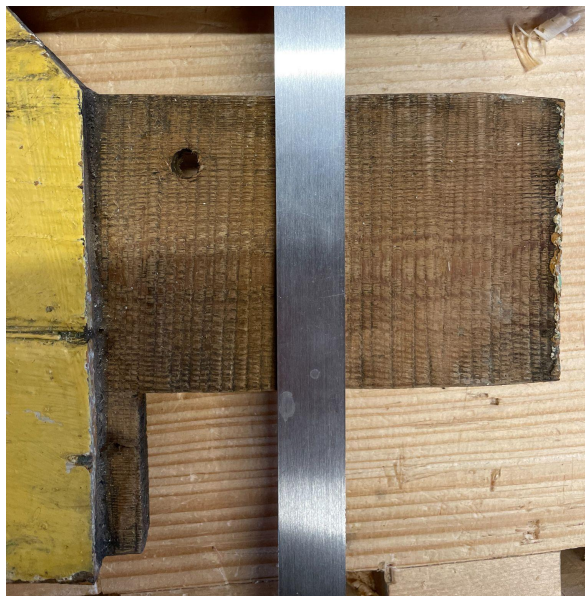
BILDE 3 – BILDE AV SAGSPOR PÅ TAPP, LINJALEN STÅR 90° PÅ EMNET.
