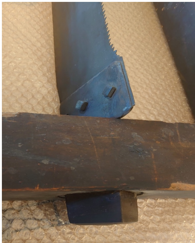
BILDE 88 - INNFESTING RAMMESAG DM. 14356
