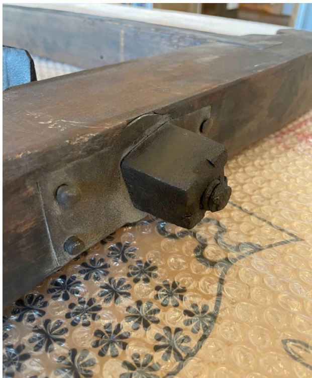
BILDE 90 – STRAMMEMUTTER RAMMESAG DM. 18842
