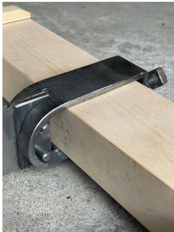
BILDE 112 - STRAMMEMEKANISME RAMMESAG "BESTEMOR"
