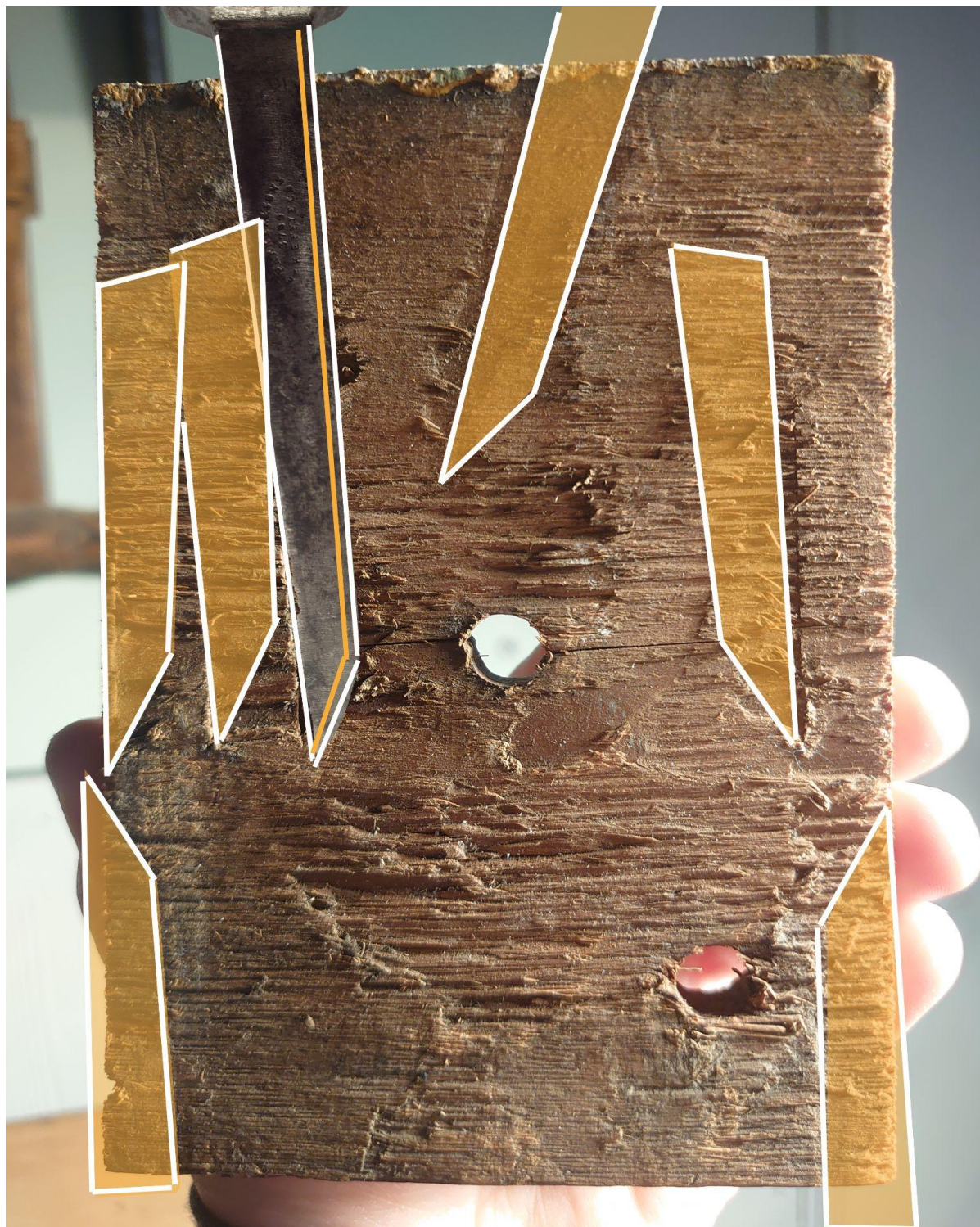
BILDE 79 – HER ILLUSTRERER VI SPOR ETTER LOKKBEITEL DER VI KUNNE TYDELIG SE DET. VI OPPLEVDE DET SOM VANSKELIG Å TREKKE NOE SYSTEM UT AV DISSE SPORENE.
