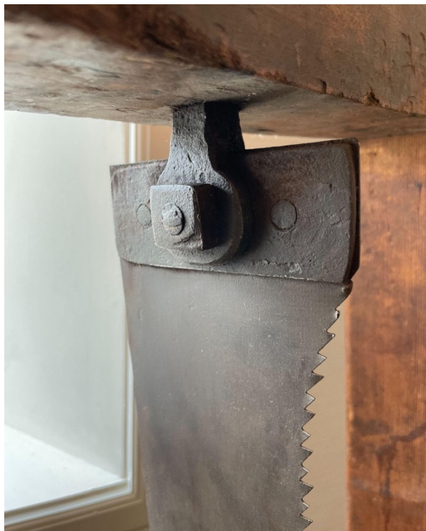
BILDE 91 – INNFESTING AV SAGBLAD DM. 14263
