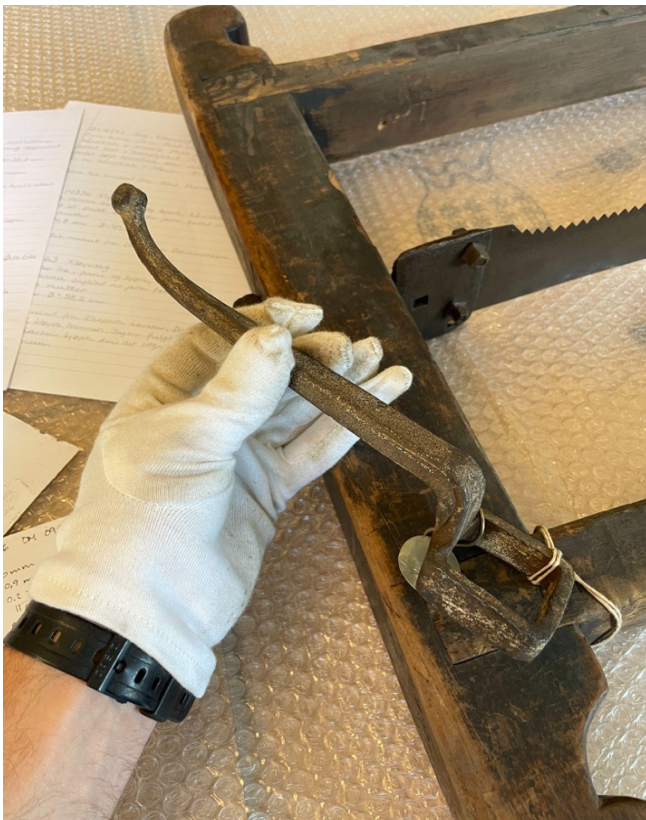
BILDE 94 - VERKTØY FOR STRAMMEMUTTER DM. 18842
