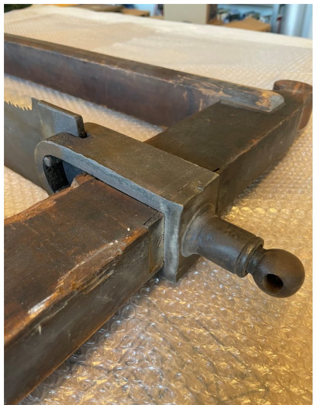
BILDE 95 – STRAMMEMEKANISME DM. 09072
