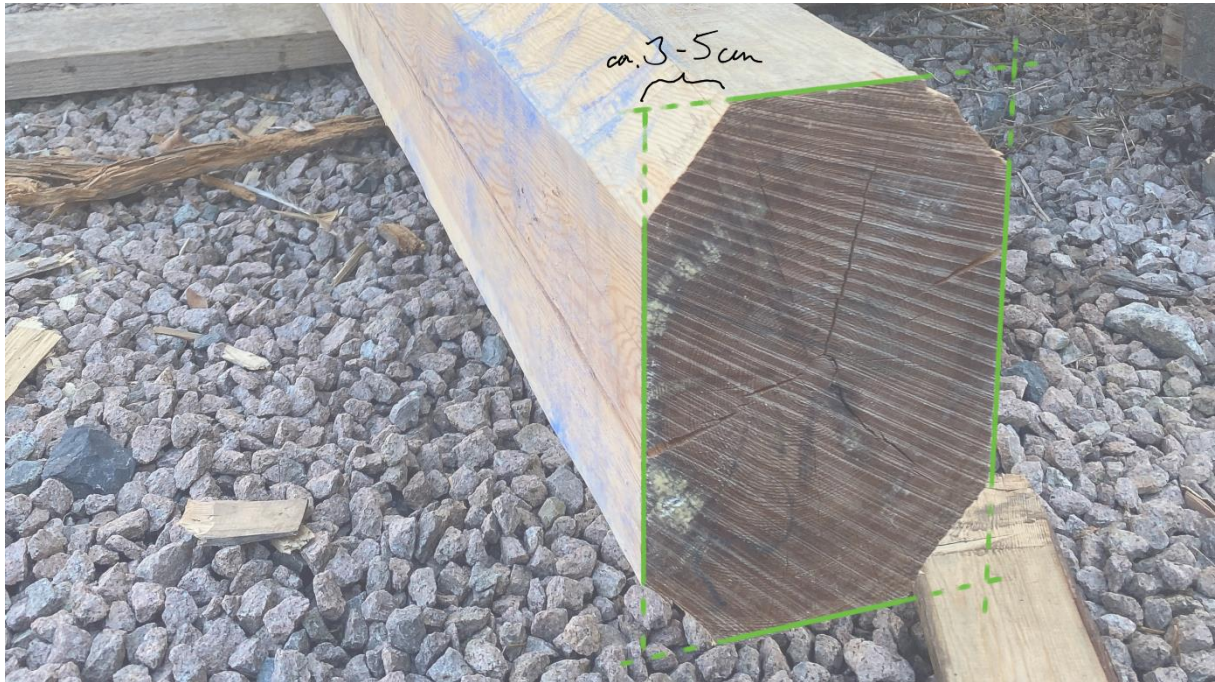
Figur 37 Stokk etter grovtilvirking Illustrasjon: Jortveit, Foto Jortveit/Ryen
