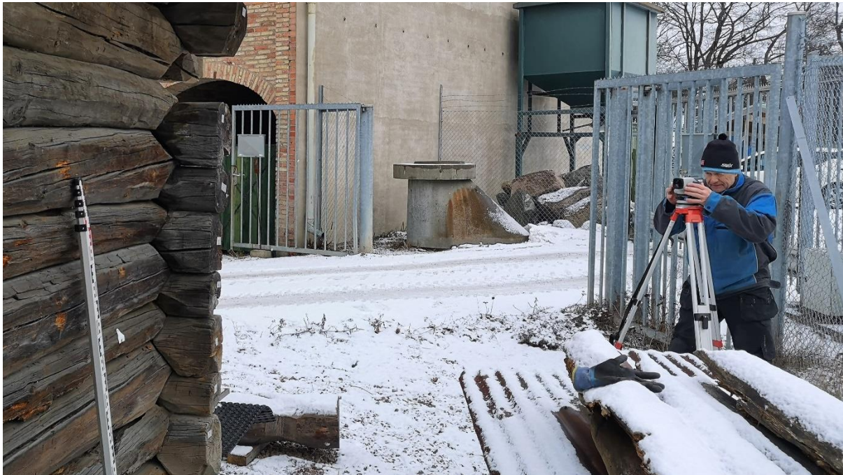
Figur 34 Nivellering av referansepunkter Foto: Jortveit/Ryen
