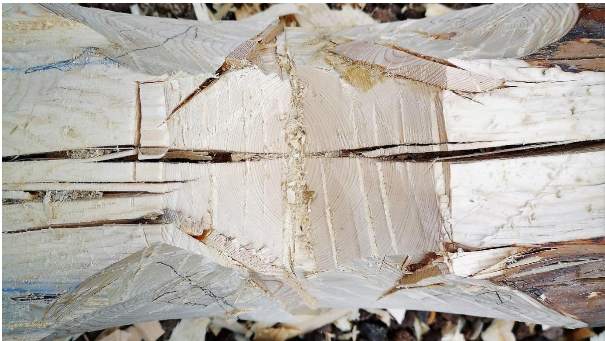
Figur 50. Kiler til å sprengte ut kinningene kalles en svenske Foto: Jortveit/Ryen
