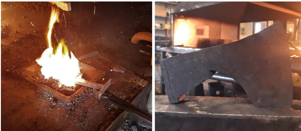
42 og 43. Før vi begynte prøvetømringa var vi i smia hos Pål Lien på Kvam og vi fekk smi koper av gamle médrag og Pål smidde ei 5"laftebile til meg. (foto, Høgnes)
