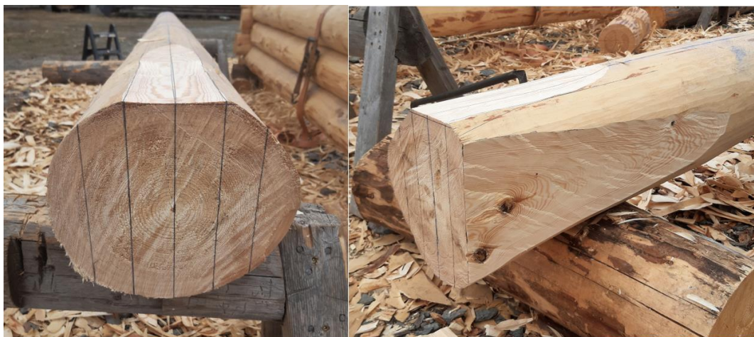
54 og 55. Stokken flata på ryggen og merka for halsing, så ferdig halsa. (Foto:Høgnes)
