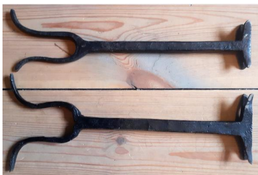
44. Médrag med maur, original gamal øvst og nest den eg smidde som kopi. Det var ikkje enkelt å smi med gamalt jern. (Foto; Høgnes)
