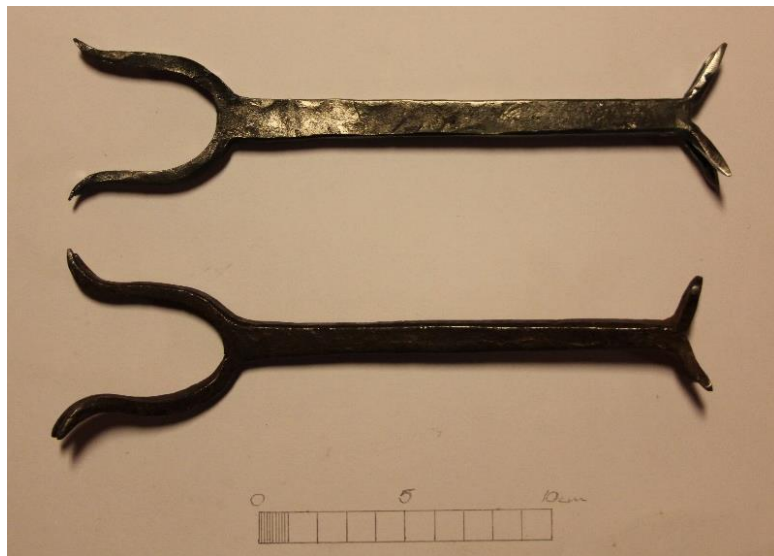
81. Mé nr 1 som vart nytta under arbeidsforsøket. Øvste er kopi og den nederste er den opphavlege méden
