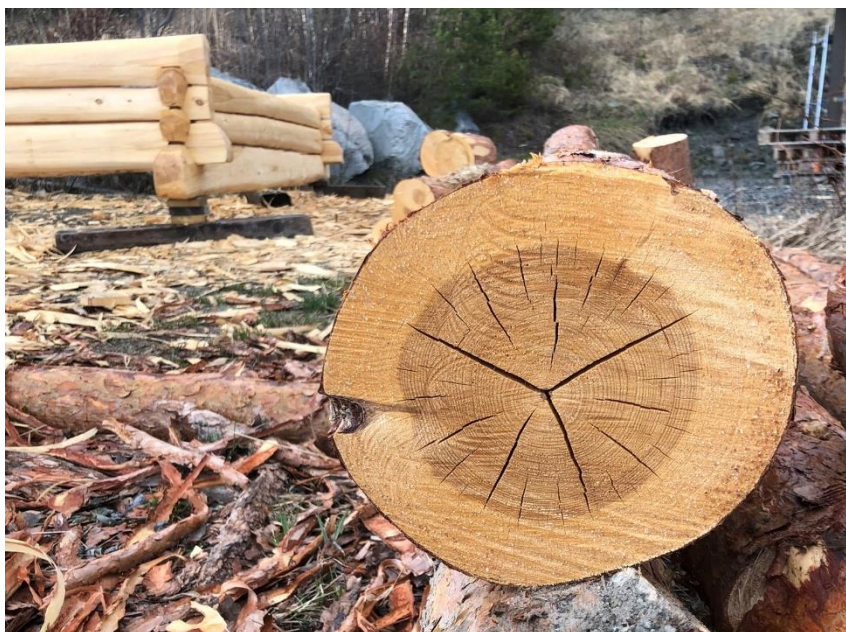
108. Korleis ein av stokkane som er skore med kjedesag ser ut. Bilete er teke 10 mai. (Foto: Selsjord)
