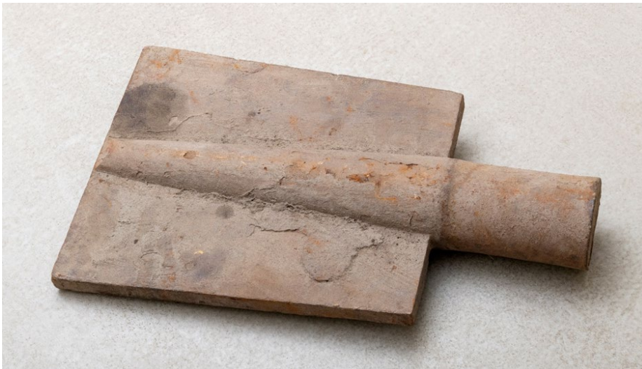
Figur 35 Bladtapp, brukt i ytterste ende av vasshjulåsen. SJF02565. Foto: Bård Løken/ Anno Norsk Skogmuseum.
