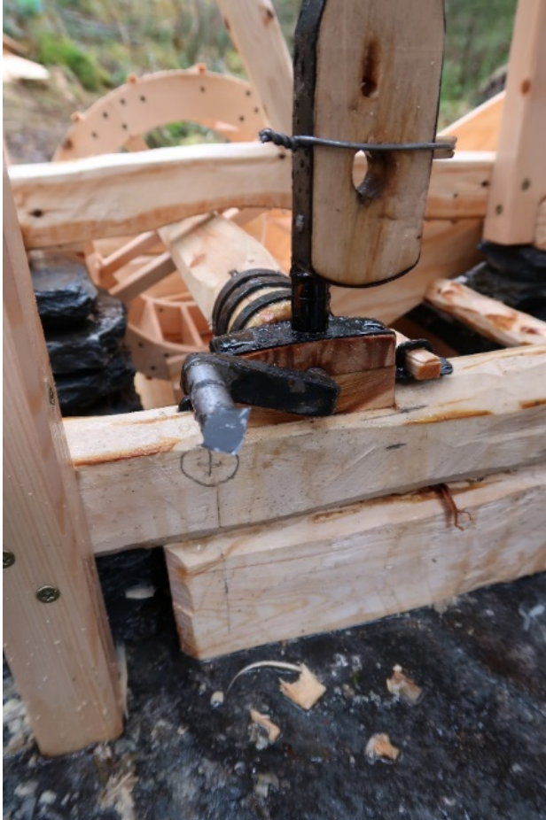
Figur 77 Reflekstape på enden av krumtappen gir målepunkt når saga går på tomgang uten sagramme og veivstang koblet på. Foto: Morten Pedersen
