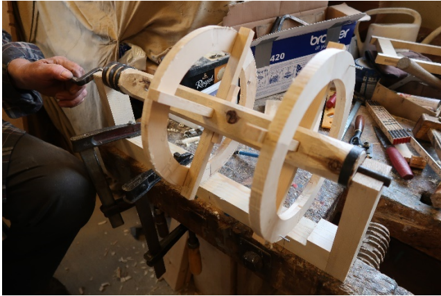
Figur 56 Eiker er felt inn i åsen, vangene sentreres. Foto: Morten Pedersen
