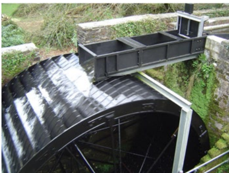
Figur 10 Restaurert overfallshjul på Brent Canvas Mill, Devon, England. I dag brukt til kraftproduksjon. Vannet slippes med lite impuls oppå skovlene. Fotograf ukjent.
