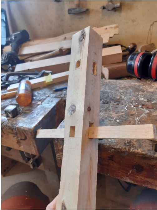
Figur 54 Eikene blir felt inn i vasshjulåsen. Foto: Morten Pedersen
