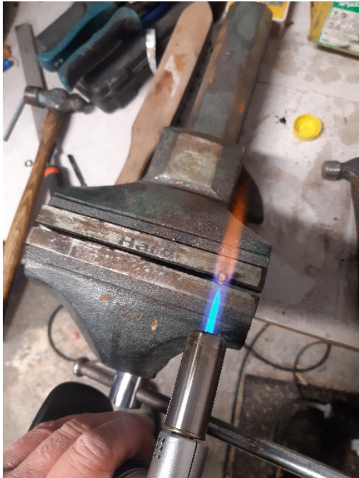
Figur 48 Smiing av hoder på boltene. Foto: Morten Pedersen
