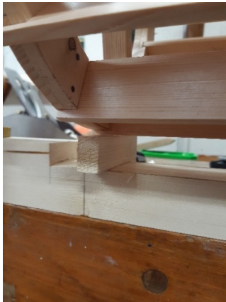
Figur 57 Skovlene finjusteres med målekloss mot slett underlag. Foto: Morten Pedersen
