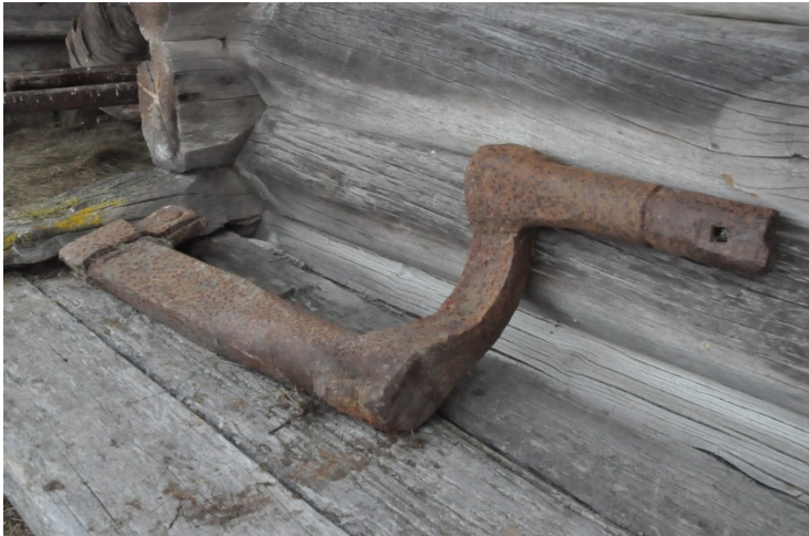
Figur 34 Krumtapp med T-fasjon. Buet arm, tangen er klinket på og knekt, mulig det er en reparasjon. Lima Hembygdsgård. Foto: Morten Pedersen
