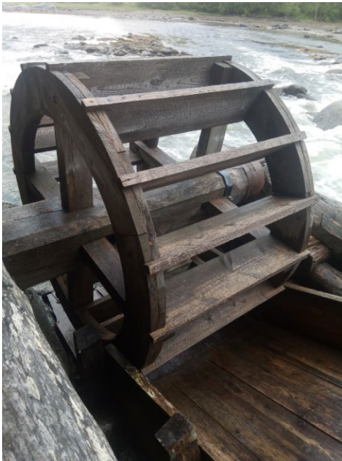
Figur 25 Vannhjulet som driver Aursfjordsaga. Foto Morten Pedersen
