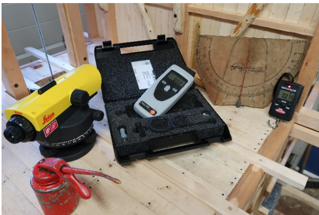
Figur 64 Utstyret som er brukt i testingen: Trankanne, Nivelleringskikkert, tachometer, loddffjøl og fiskevekt. Foto: Morten Pedersen
