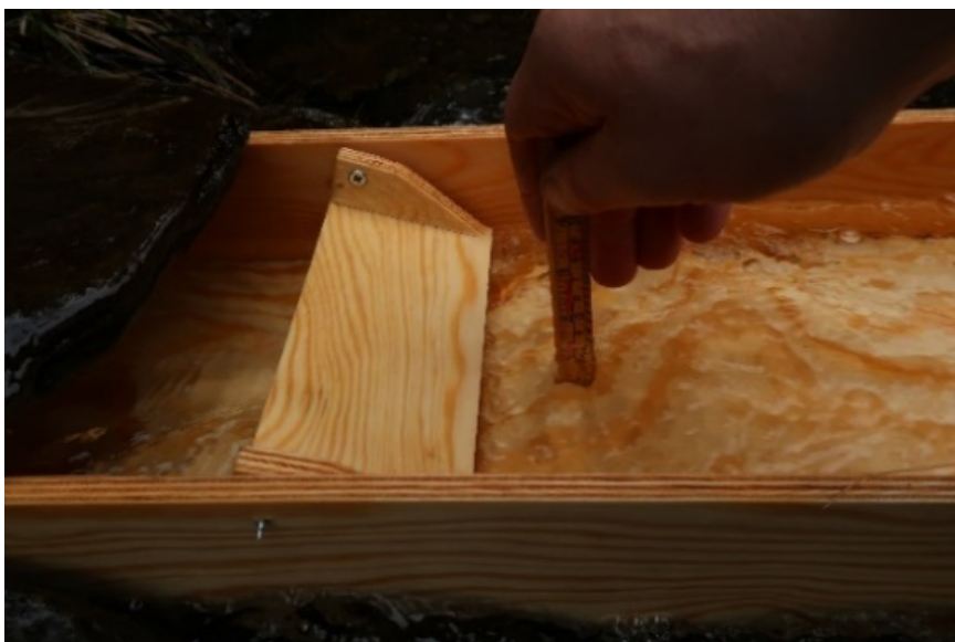
Figur 70 Måling av vannhøyde ved inntaket, nedenfor "spoileren". Foto: Morten Pedersen
