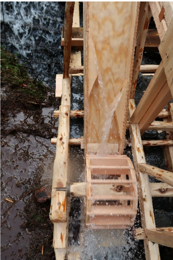
Figur 79 Kiler og terske montert rett foran hjulet. Mye sprut høyt opp i vannhjulet. Foto Morten Pedersen
