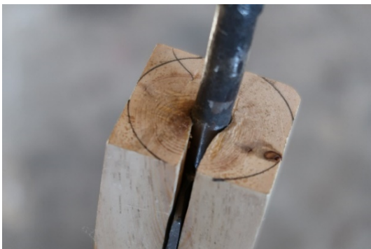
Figur 55 Krumtappen felles inn i vasshjulåsen. Foto: Morten Pedersen
