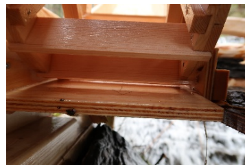
Figur 66 Åpning mellom skovler og renne. Foto: Morten Pedersen
