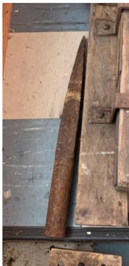
Figur 36 Nål, brukt i ytterende av vasshjulås. Fra Drevja. Foto: Jon Dahlmo.
