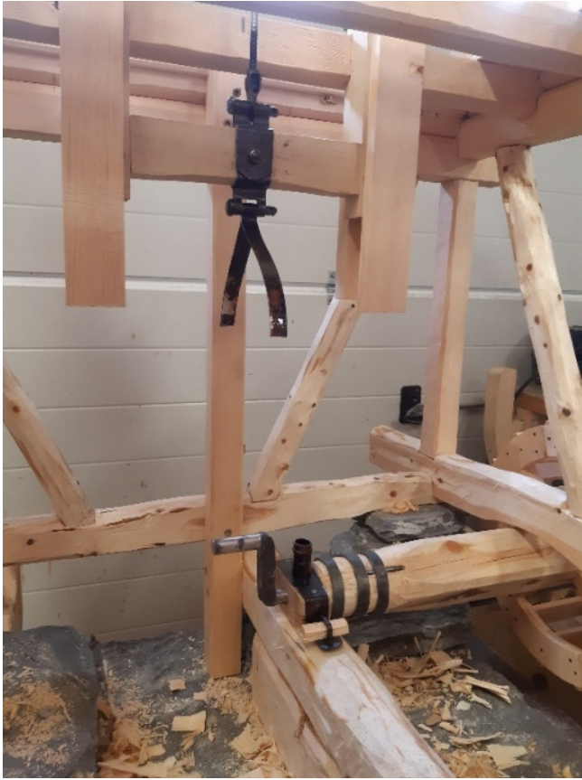
Figur 60 Sagramme med beslag, og veivlager/ vannhjul er klar for montering av veivstang. Foto: Morten Pedersen
