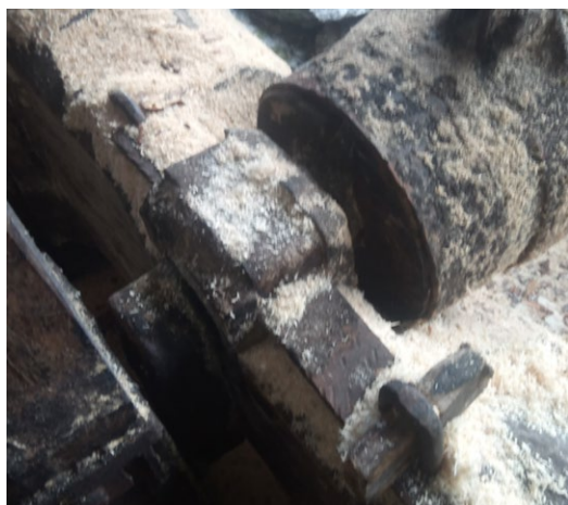
Figur 37 Lager av rikule i furu med beslag, Aursfjordsaga. Foto: Morten Pedersen
