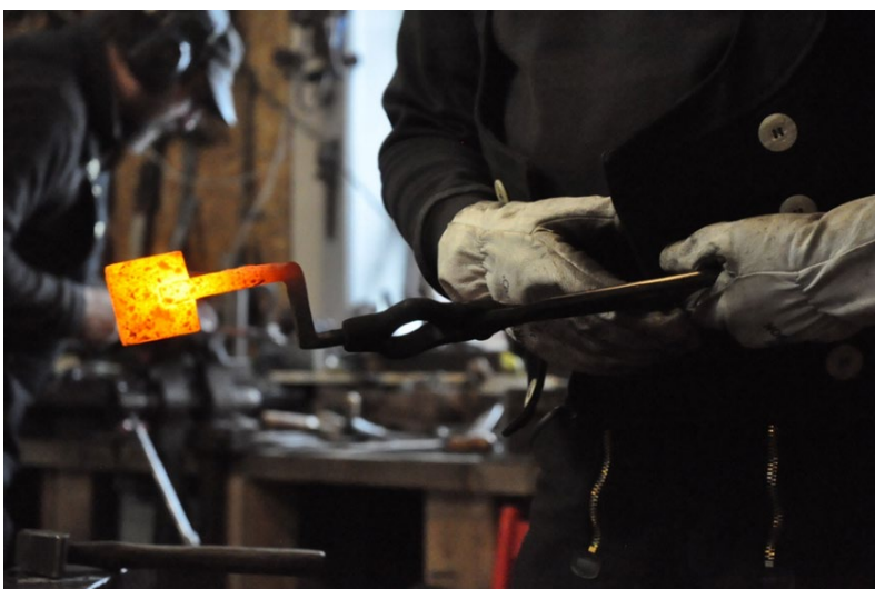
Figur 52 En krumtapp med flatt blad er underveis. Foto: Morten Pedersen
