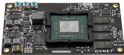
(a) UltraZed-EV SOM Top View [11]
