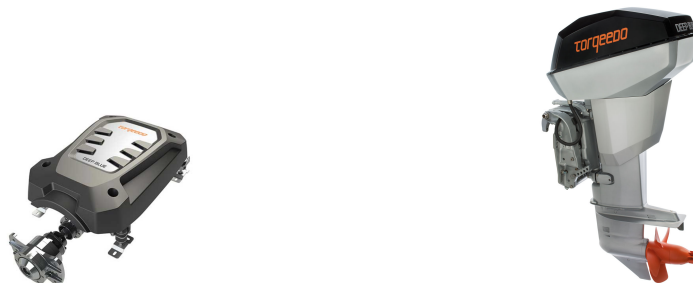
(a) Hvordan en elektrisk innenbordsmotor fra Torqueedo ser ut uten propellsystem. Hentet fra (Torqueedo, 2022) (b) Hvordan en elektrisk utenbordsmotor ser ut fra Torqueedo. Hentet fra (Torqueedo, 2022)
