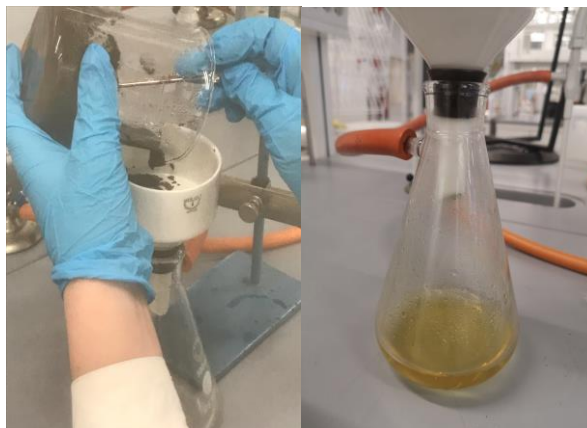
Figur 12: Filtrering av syreløsningene med büncher filter, og en filtrert løsning.
