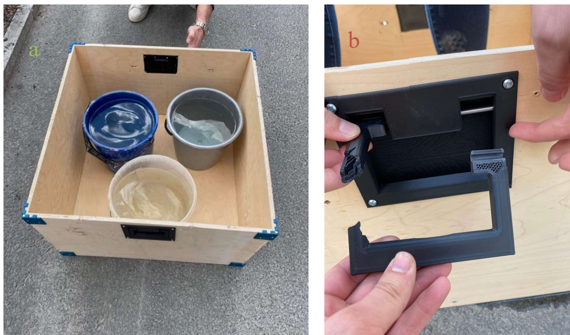
Figur 41: a) Last-test 30kg b) Håndtak etter brudd
