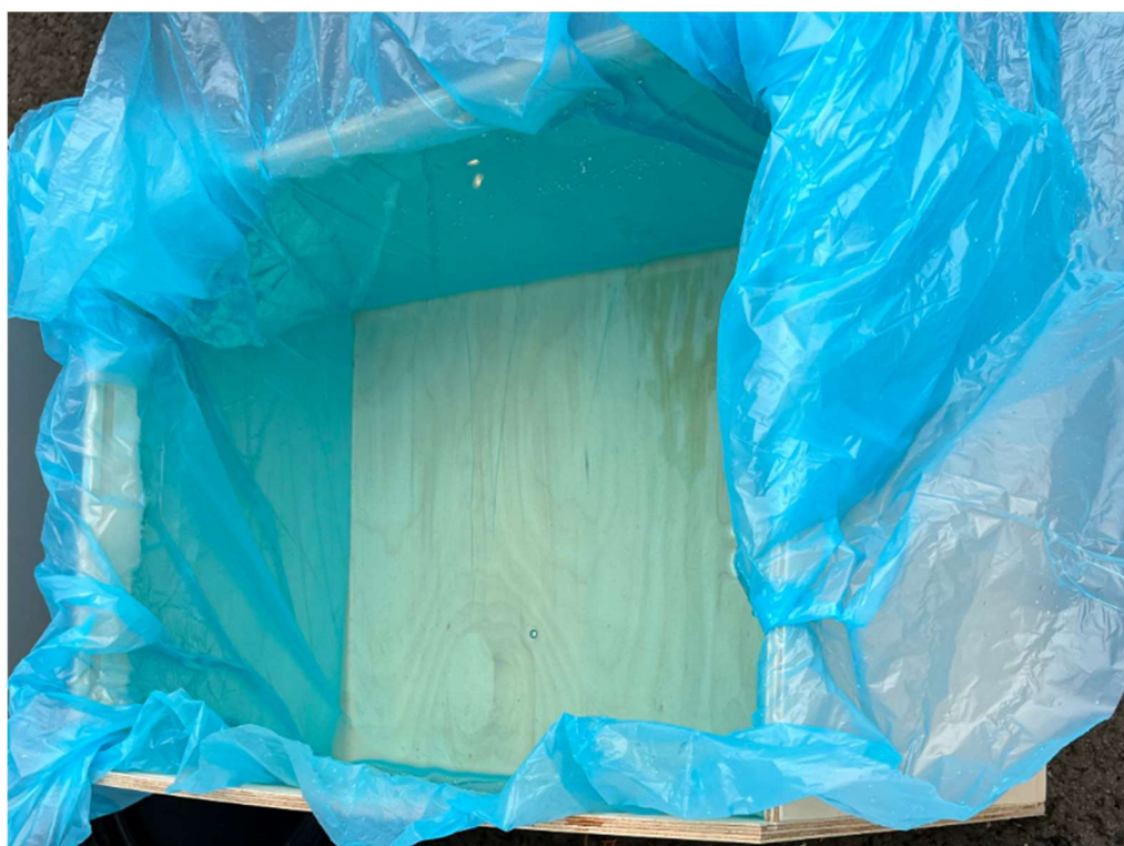
Figur 40: Lasttesting med vann av boks med 6mm plater
