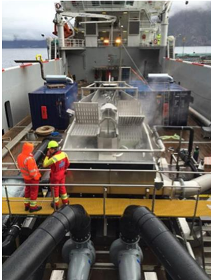
Figur 4: Optilicer med varmtvannsbad og to separate skovlehjul. Skovlejhjulene skyver fisken gjennom et lite kar med oppvarmet sjøvann. Består av en oljebrenner som varmer opp vannet, behandlingskar, CO 2 -utlufting og oksygenering. Vannet avsiles gjennom et trommefilter som filterer ut lus og egg. Bilde fra: (Roth, 2016)
