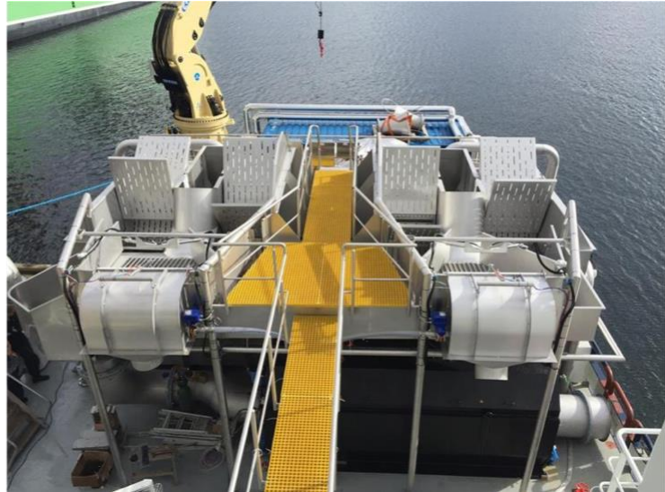
Figur 4: Optilicer med varmtvannsbad og to separate skovlehjul. Skovlejhjulene skyver fisken gjennom et lite kar med oppvarmet sjøvann. Består av en oljebrenner som varmer opp vannet, behandlingskar, CO 2 -utlufting og oksygenering. Vannet avsiles gjennom et trommefilter som filterer ut lus og egg. Bilde fra: (Roth, 2016)
