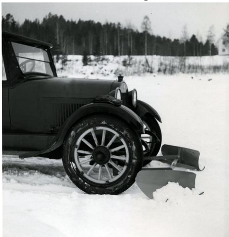
Figur 1.1 Verdens første snøplog til bil Denne snøploen ble laget av Øveraasen i 1923, og var verdens første snøplog montert på bil (Øveraasen AS, 2021a).
