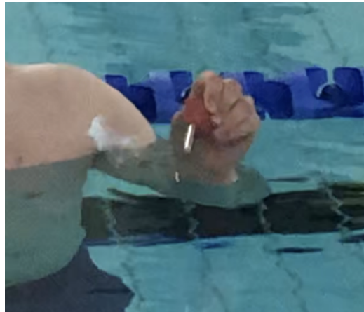
Figur 4.8: Røyforsøk i svømmehall
