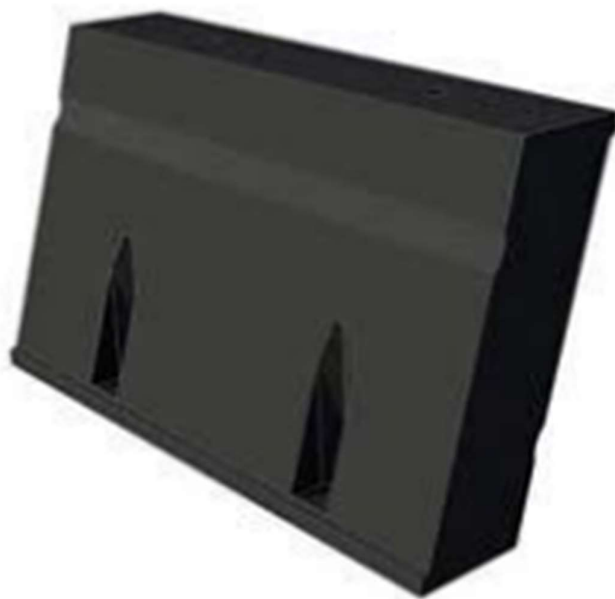
Figur 36: 3D visualisering av benelementfender som planlagt i Teknisk forprosjekt. Kilde: [36].
