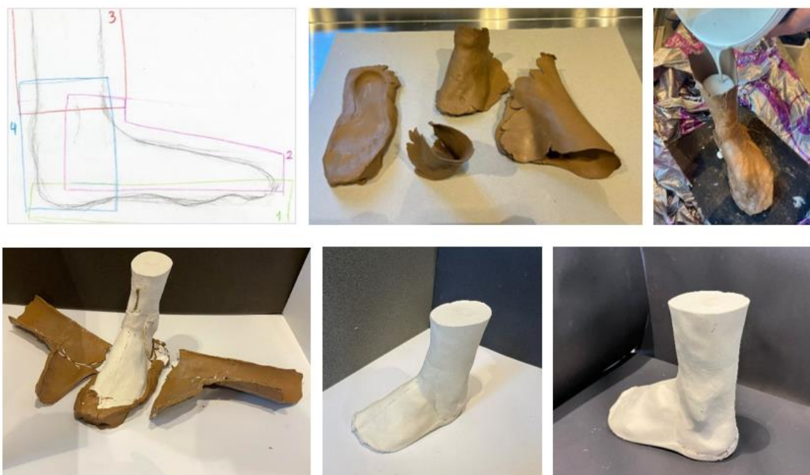
Figur 10, Støpningsprosessen av ankelmodellen (Foto: S.K. Lindbeck, 2022)
