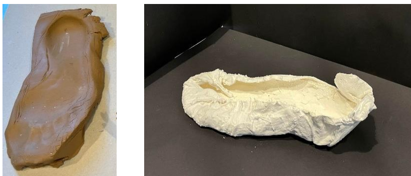
Figur 44, Test av støping med gips vs. industriell plastelina (foto: S.K. Lindbeck, 2022)
