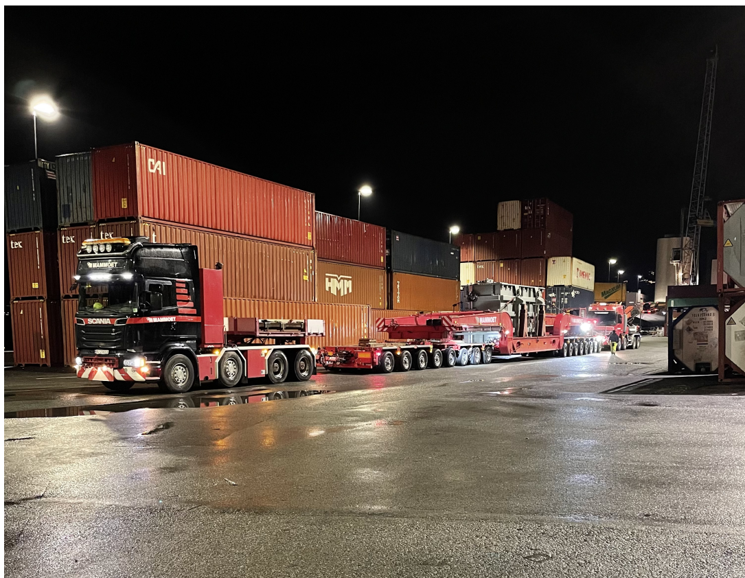
Figur 4.7: Bildet viser en del av transporten av den 120 tonn tunge lasten med den havarerte T-11.
