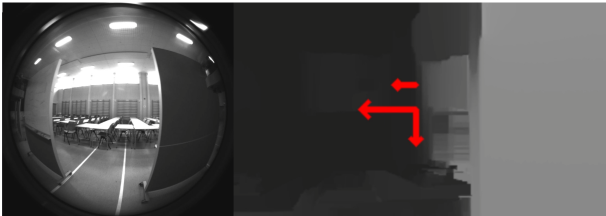
Figur 16: Direkte video fra dronen og dybdekart med illustrering av respons fra fuzzy kontroller.
