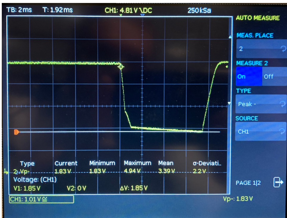
Figur 25: Måling av spenningsforsyning til Pi fra BEC
