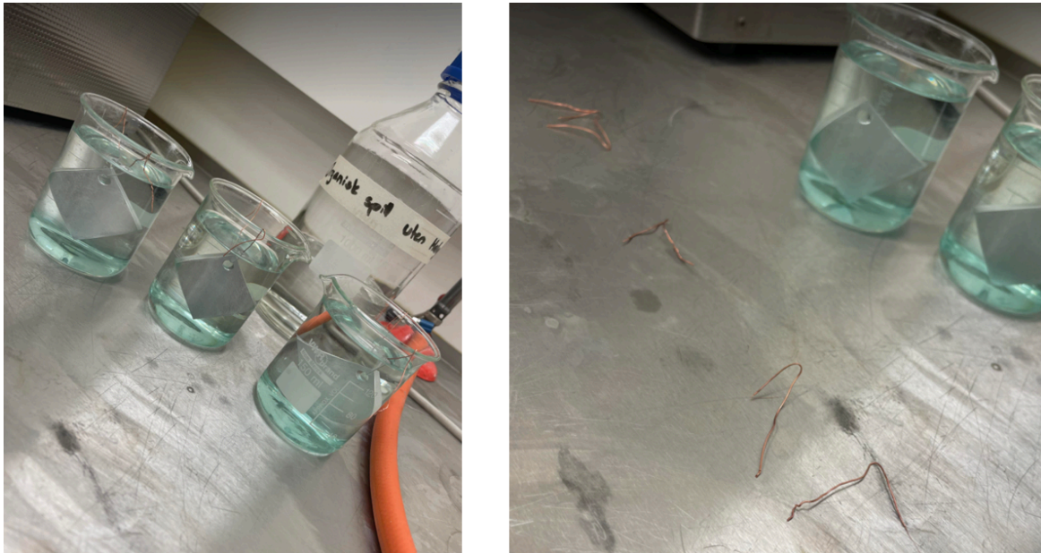
Figur 12: Figur (a) viser passivering med 33% salpetersyre med kobbertråd til opphenging, mens (b) viser oppløsningen av disse trådene.
