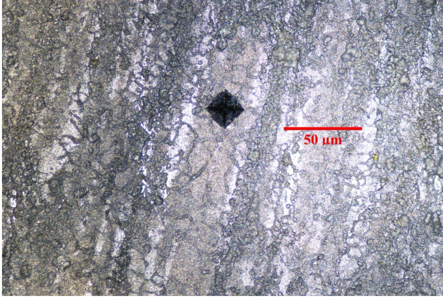
Figur 57: Figuren viser lysmikroskopbilde av prøve 3 passivert med salpetersyre etter test med Vickers hardhetsmåler.
