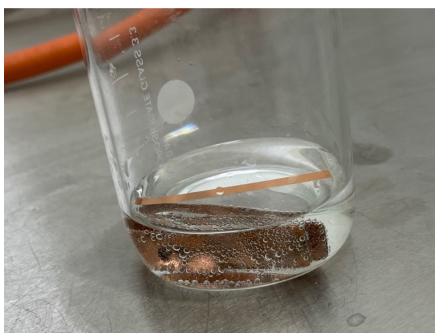
Figur 24: Figuren viser en kobberbit tilsatt hydrogenperoksid for å observere grad av gassdannelse.
