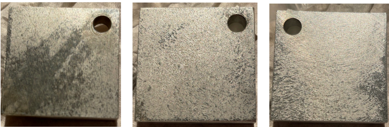
Figur 16: Figur (a) viser resultat fra prøve 4 ved passivering med sitronsyre, (b) og (c) viser resultat fra prøve 3 og 2.
