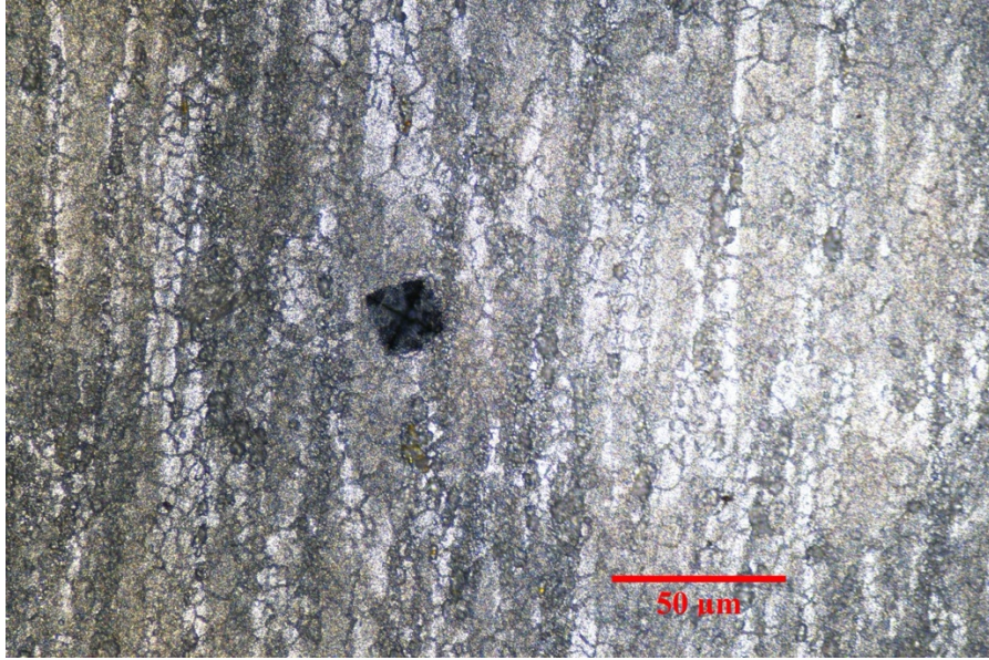
Figur 63: Figuren viser lysmikroskopbilde av prøve 9 passivert med salpetersyre etter test med Vickers hardhetsmåler.
