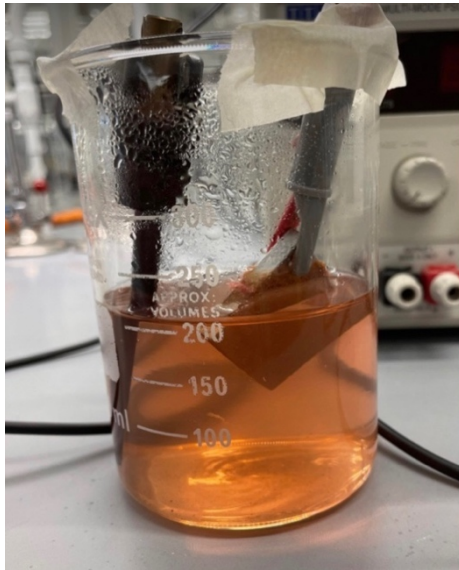
Figur 19: Figuren viser bilde av (a) anodiseringsprosessen av prøve 3, og (b) er bilde av ferdig resultat prøven.
