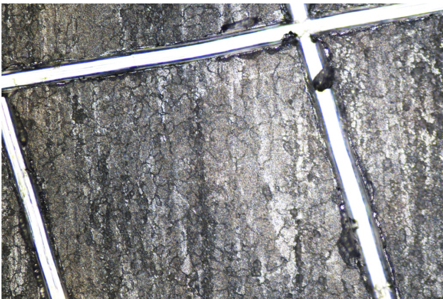
Figur 50: Figuren viser lysmikroskopbilde av prøve 9 passivert med salpetersyre etter utført Cross-hatch Cutter test.
