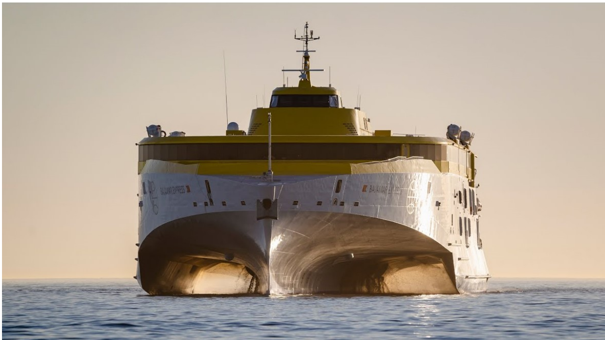
Figur 9.5: Typisk bruk av trimaranskrog på hurtiggående ferger[11]
