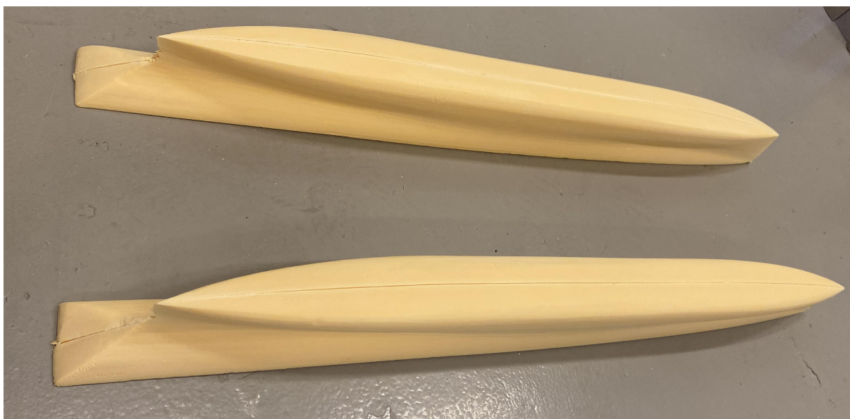
Figur 12.3: Pusset og limte skrog klar for epoksy
