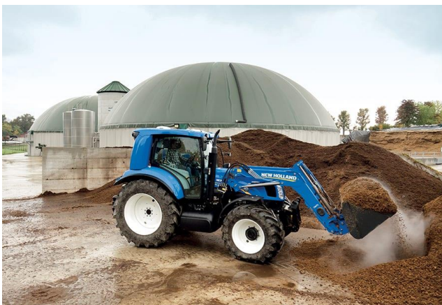
Bilde 2: New Holland T6.180 Methane power med tanker på hytta. Det verserer flere bilder med tanker på forskjellige steder på traktoren, så det antas at dette bare er en av løsningene. (New Holland Brand Communications, 2021).
