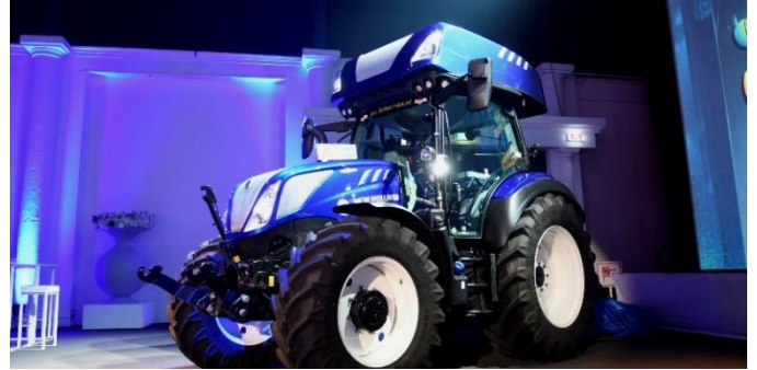
Bilde 4: New Holland T5.140 Auto Command H2 Dual Power (Vale,2020). Hydrogentankene ligger plassert på taket av traktoren.
