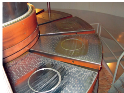
Figur 19: Defekt metall bærelager, [15]
