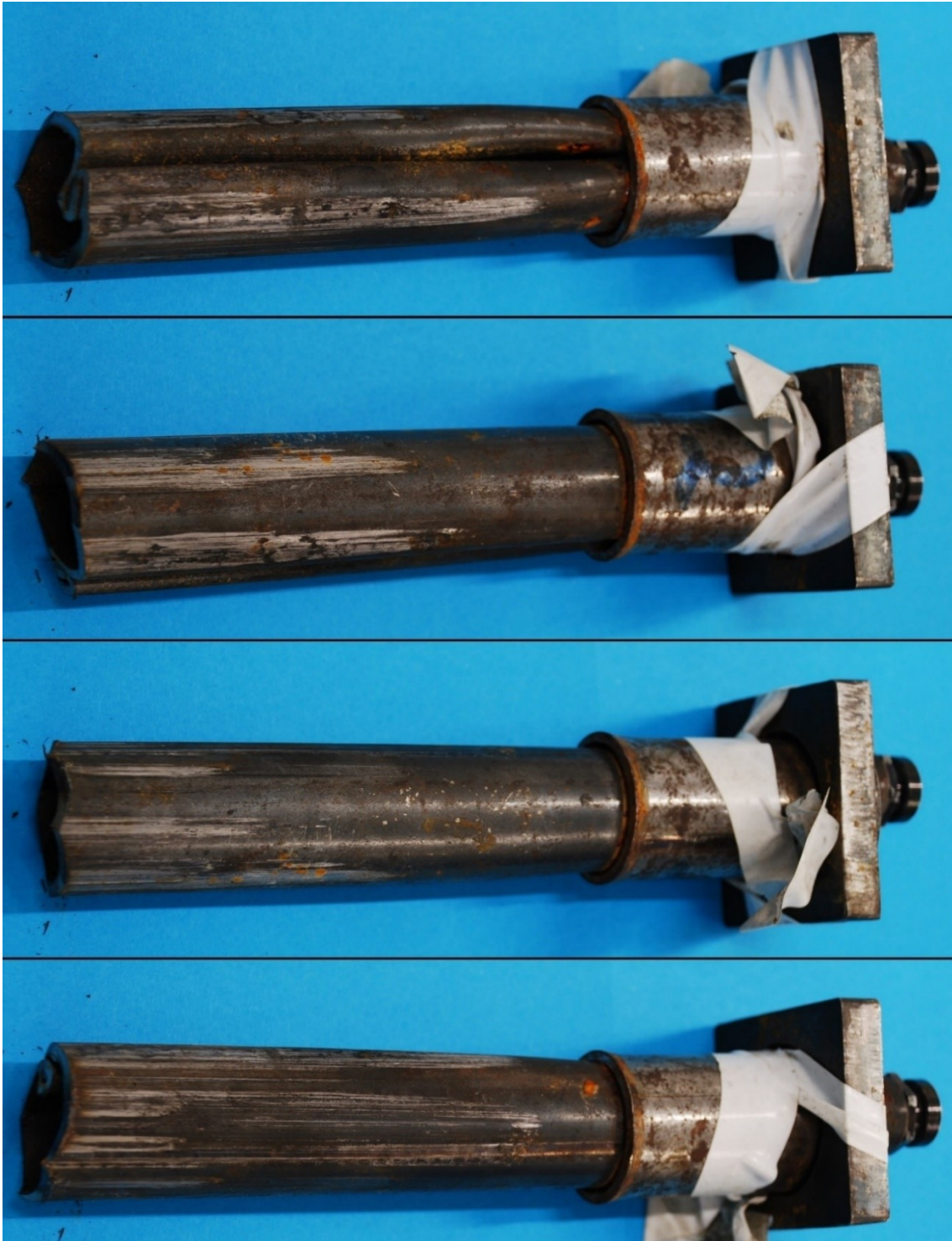
Figur 4. 10: Slipemerkene på bolten etter uttrekkstest angir kontakten mellom boltene og hullveggen. Det observeres seksjoner og striper uten kontakt.
