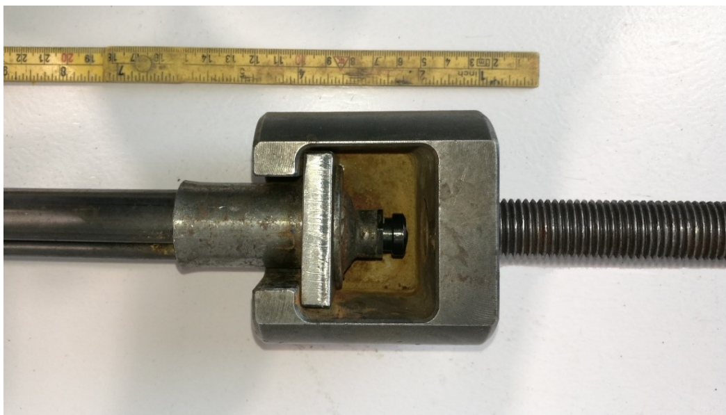
Figur 3. 6: Gjengestag heftet på boltene for å utføre uttrekkstest.
