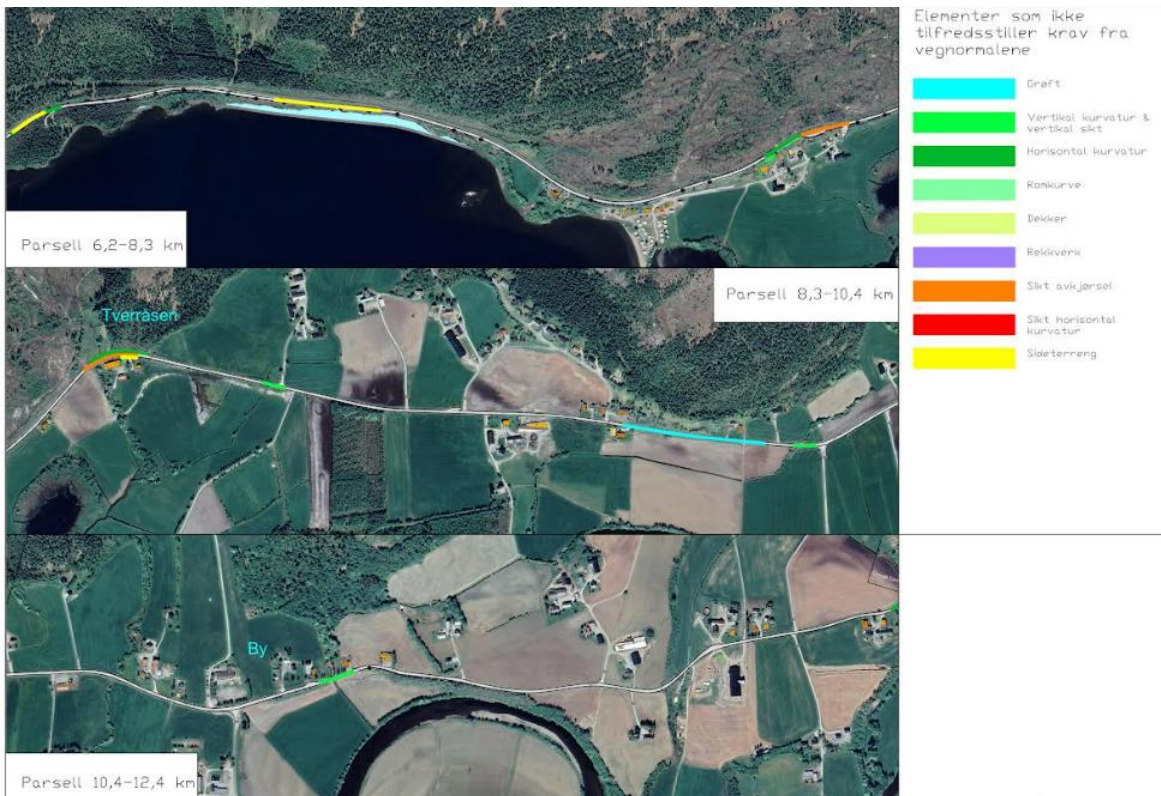
Figur 36. Parsell 6,2-12,4 km med oversikt over uoppnådde krav (ref. vedlegg D.7).
