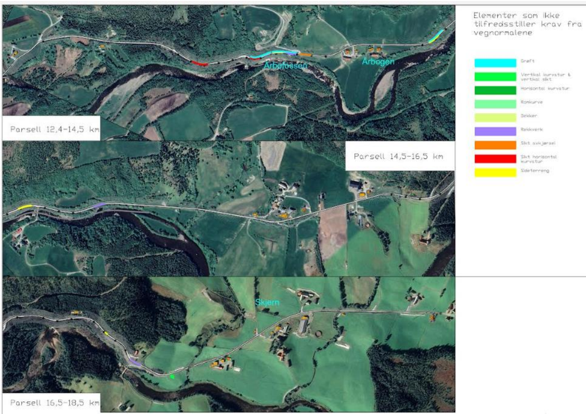
Figur 37. Parsell 12,4-18,5 km med oversikt over uoppnådde krav (ref. vedlegg D.8).
