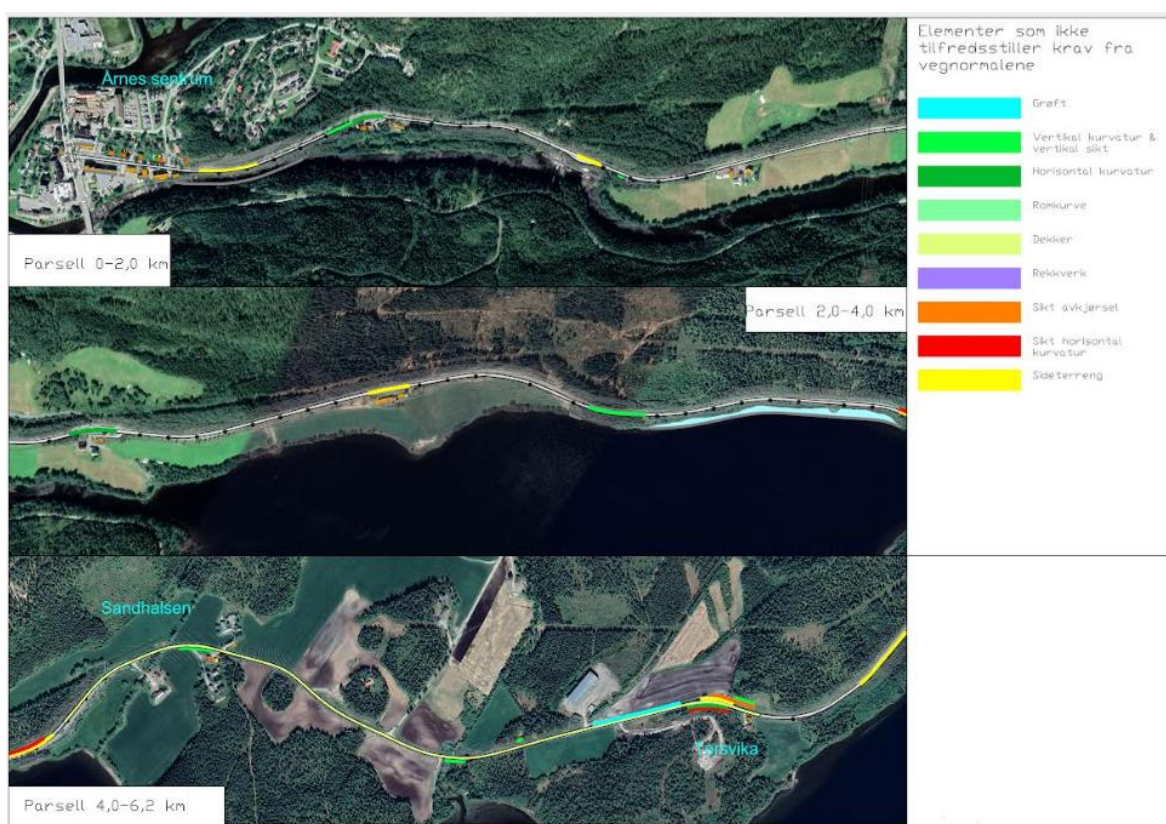
Figur 35. Parsell 0-6,2 km med oversikt over uoppnådde krav (ref. vedlegg D.6).
