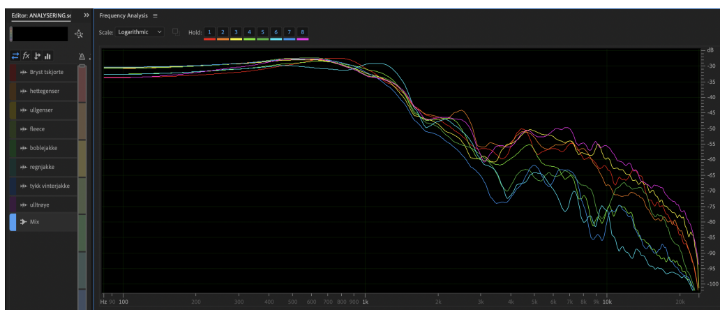
Figur. 9: Grafen viser nivåforskjeller i frekvens for flere klesplagg. Forklaring på farge vises til venste. Opptakene er tatt opp med lik setning, og med samme person.
