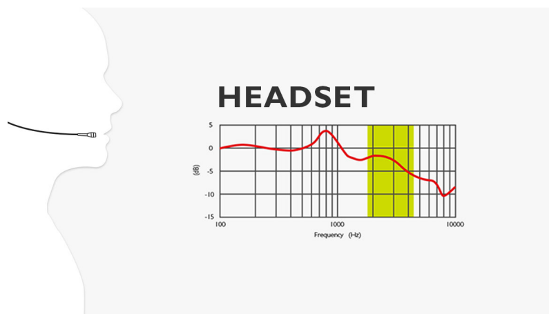
Figur. 5: Frekvensspekter ved plassering av mikrofon på kinnet.
