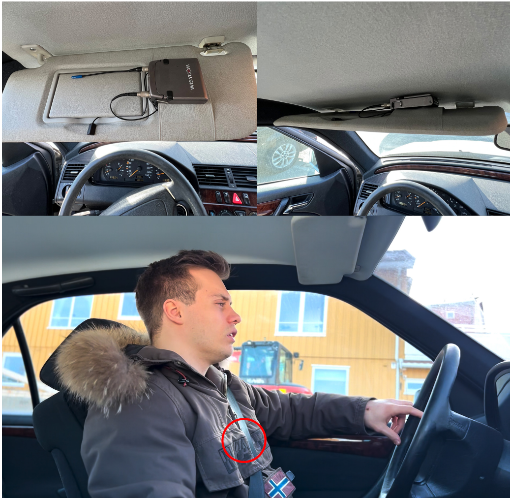
Figur. 14: Opptak i bil. Plassering av mygg i solskjerm og under brystlomme på jakke (rød markering).
