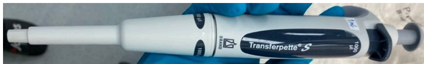
Figur 6 Den ene pipetten som ble brukt under analyse av vannprøvene. Pipetten målte kun 1000 µl, og var ikke justerbar.
