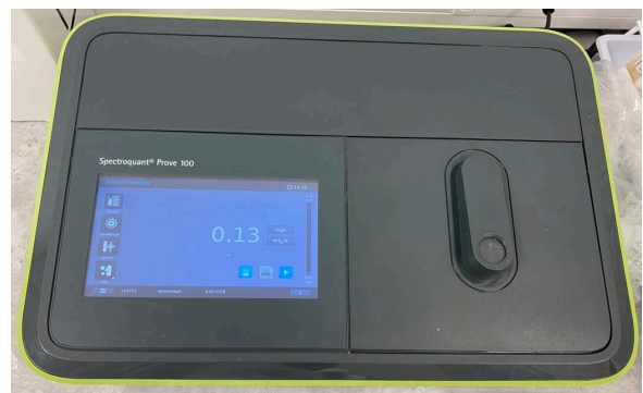
Figur 7 Spektrofotometeret av typen Spectroquant® Prove 100, analyserer vannprøvene ved hjelp av lysgjennomtrenging.
