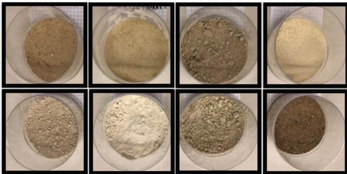
Figur 26: Åtte pulverprøver, fra øverst venstre mot høyre: Frysetørket Rå, Frysetørket Topplag, Frysetørket Bunnlag, Frysetørket Nanofiltrert. Fra nederst venstre mot høyre; Spraytørket Rå, Spraytørket Topplag, Spraytørket Bunnlag, Frysetørket Vakuumkonsentrert.
