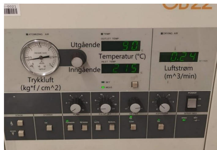
Figur 14: Verdiene for temperatur på inngående og utgående luftstrøm, hastighet på luftstrøm, samt lufttrykk ved dysen under spraytørkeprosessen
