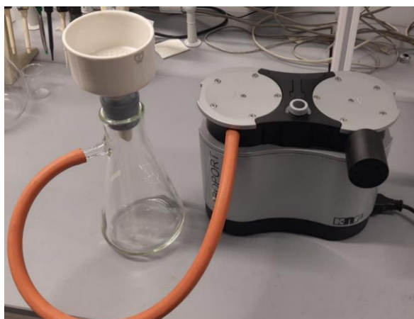
Figur 10: Laboport N 820G med vakuumkanne, som benyttes her for å filtrere rått hydrolysat med Blue Ribbon 589/3
