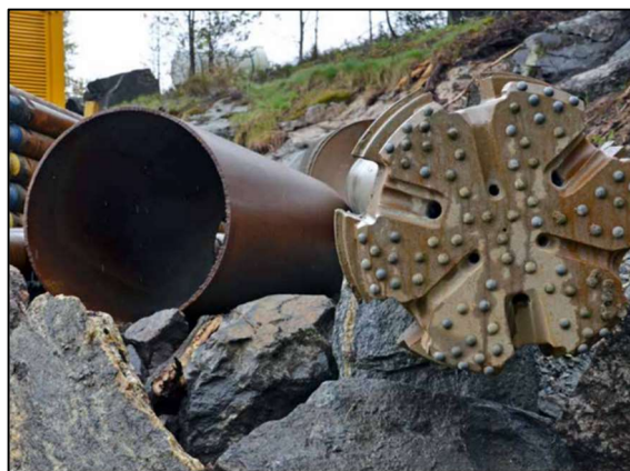
Figur 24 – Borekrone og godsrør for hammerboring, figur hentet fra (Olimb AS, 2018)
