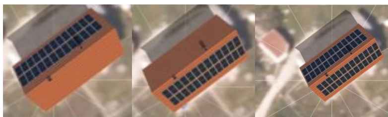
Figur 56: Venstre - Konfigurasjon 1 med solceller retter nordvest
