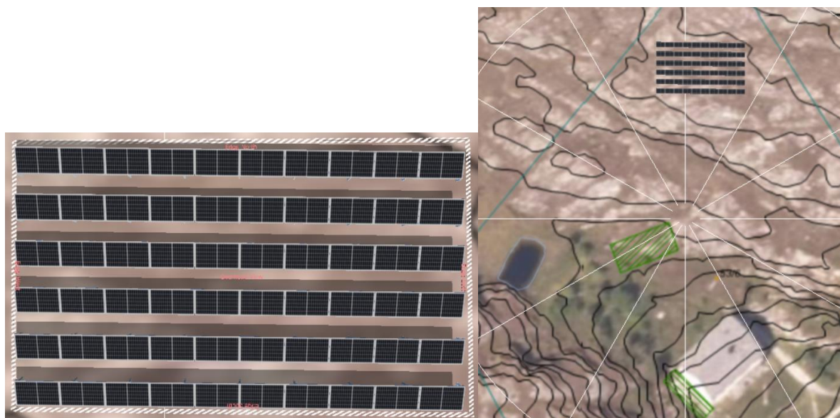
Figur Solpark med 60 paneler i sørvendt konfigurasjon. Venstre: nærbilde, Høyre: oversiktsbilde
