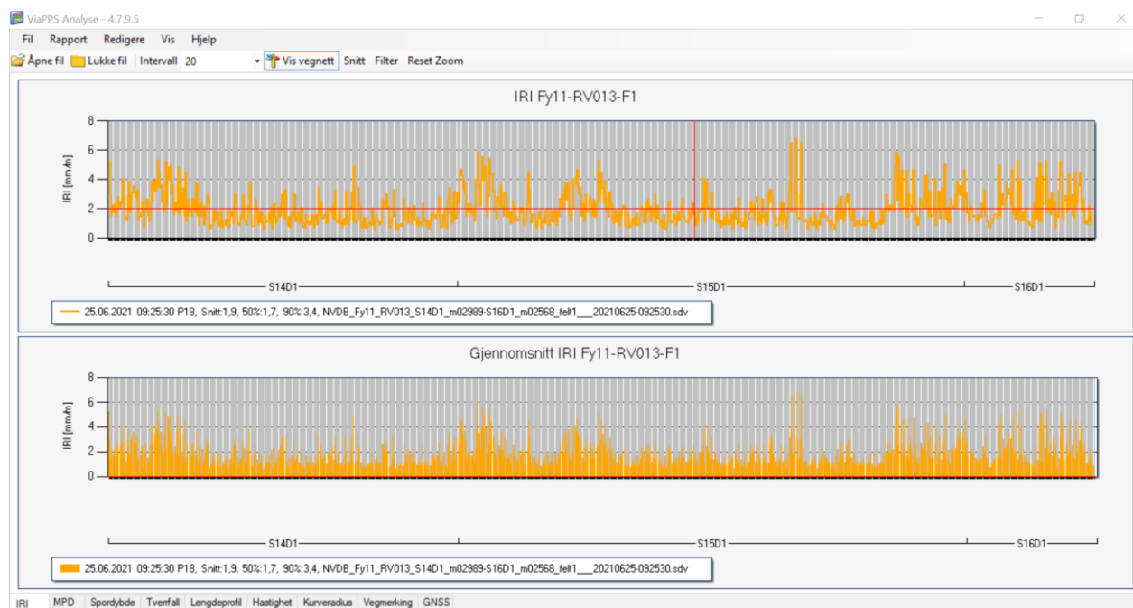
Figur 14: Slik ser IRI målinger ut i ViaPPS Analyser
