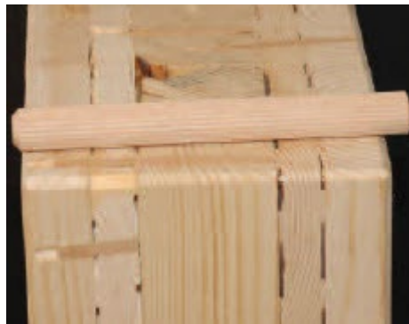
Figur 2.15. Krysslagte elementer sammenføyd med tredybler [16].
