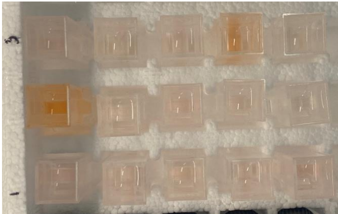
Figur 20: Fettfasen pipettert over i kyvetter. Prøveparallell tre (øverst) til en, med prøver fra venstre: referanse, uten antioksidanter, dobbel askorbinsyre, dobbel rosmarinestrukt og tokoferol, alle fra dag 7. (Foto: Lier, 2022)
