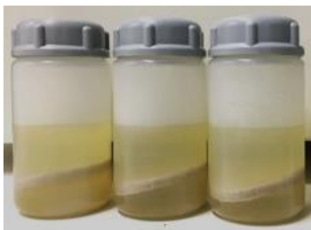
Figur 14: Sentrifugekopper med kloroform og lipider i den nederste fasen (Foto: Jensen, 2022)
