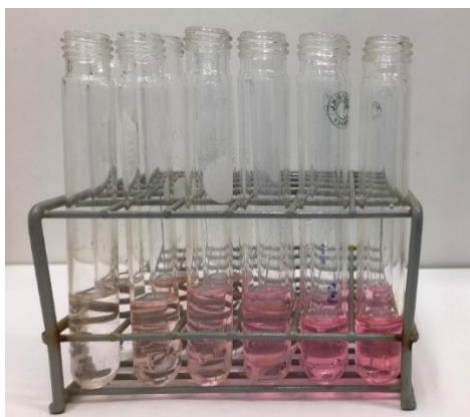
Figur 18: Kimaxrør med ulike mengder TEP-løsning som utgjorde standardkurven (Foto: Jensen, 2022)
