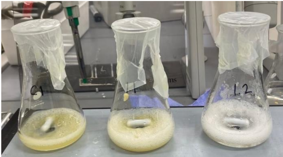
Figur 6: Oppsettet av selvetablert simulert modell av fordøyelsessystemet etter tilsetning av enzymer. Kolben til venstre inneholder kontrollprøven uten sjøpølse med tilsatt enzym, kolben i midten inneholder sjøpølse fordøyd med tilsatt enzym og kolben til høyre inneholder sjøpølse fordøyd uten tilsatt enzym.
