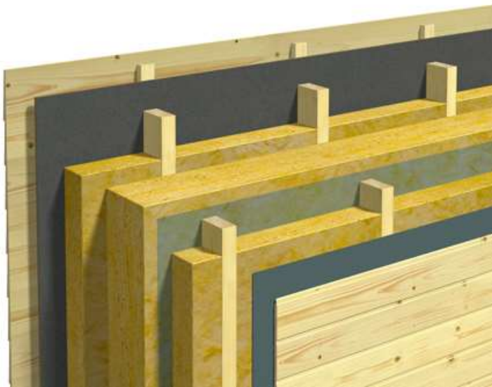
Figur 34: Prinsipiell oppbygning av todelt vegg med stender i heltre. Hentet fra: [68]
