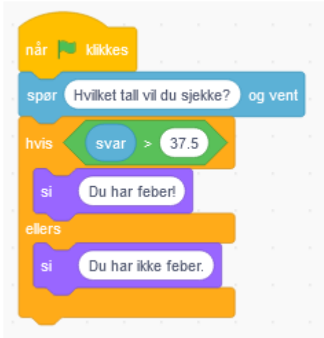
Figur 5-115: Oppgave 3: Sammenligning av to tall, bruk av hvis/ellers i Scratch
