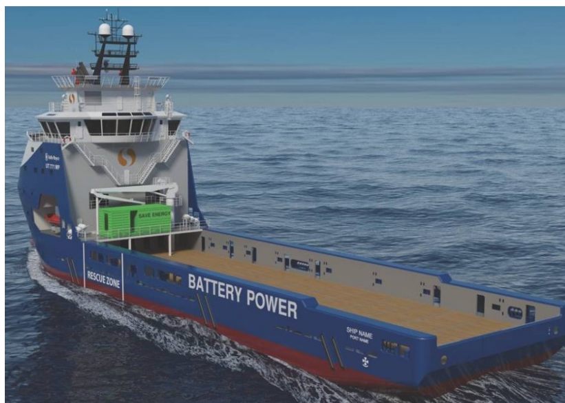
Figur 3.3: Eksempel på hvor battericontainer kan plasseres på dekk. Figuren er hentet fra MarineLink [70].
