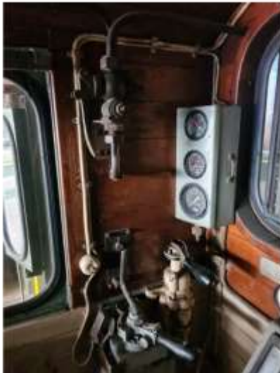
Handler til fart, bremsor og togfløyta (øverst) samt Brett med måleinstrumenter/speedometer? Eget fotografi.
