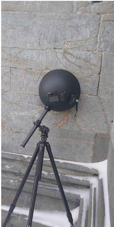
Figur 4 RTI-domen med stativ. Fra utprøving av utstyret februar 2020 på Nidarosdomen. Foto: A. Skre
