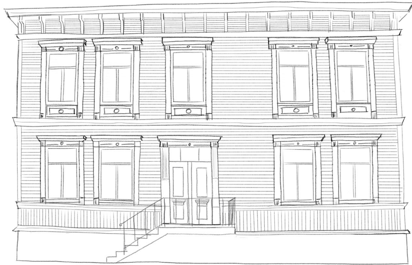
Skisse av typisk fasade på møllenberg med mye ornamentering. Vindus- og dørromramming med utskjæringer. Dørblad med speil og lister. Horisontale bånd i form av vassbrett, midtgjort og gesimsbånd.
