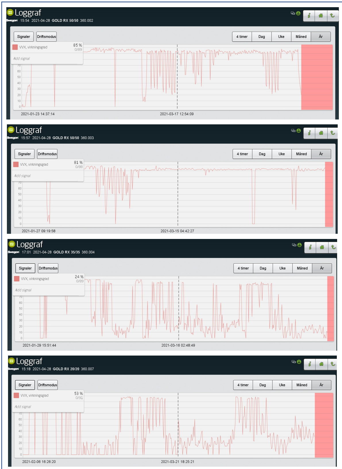
Figur 36 - Loggrafer av varmegjenvinningsgrad fra SD-anlegget
