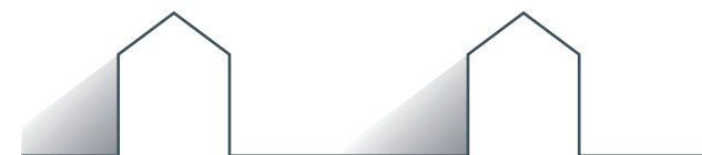
Lys i gata var viktig for gjenreisningen. Bygningene fikk være 3 etasjer i byen og 4 ned mot havna.
